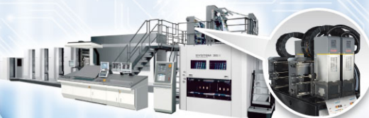
オフ輪印刷機に搭載のインクジェットヘッド
